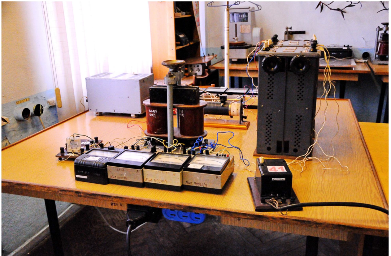
Рисунок 2 - Загальний вигляд лабораторного стенда для дослідження характеристик котушки з феромагнітним осердям
