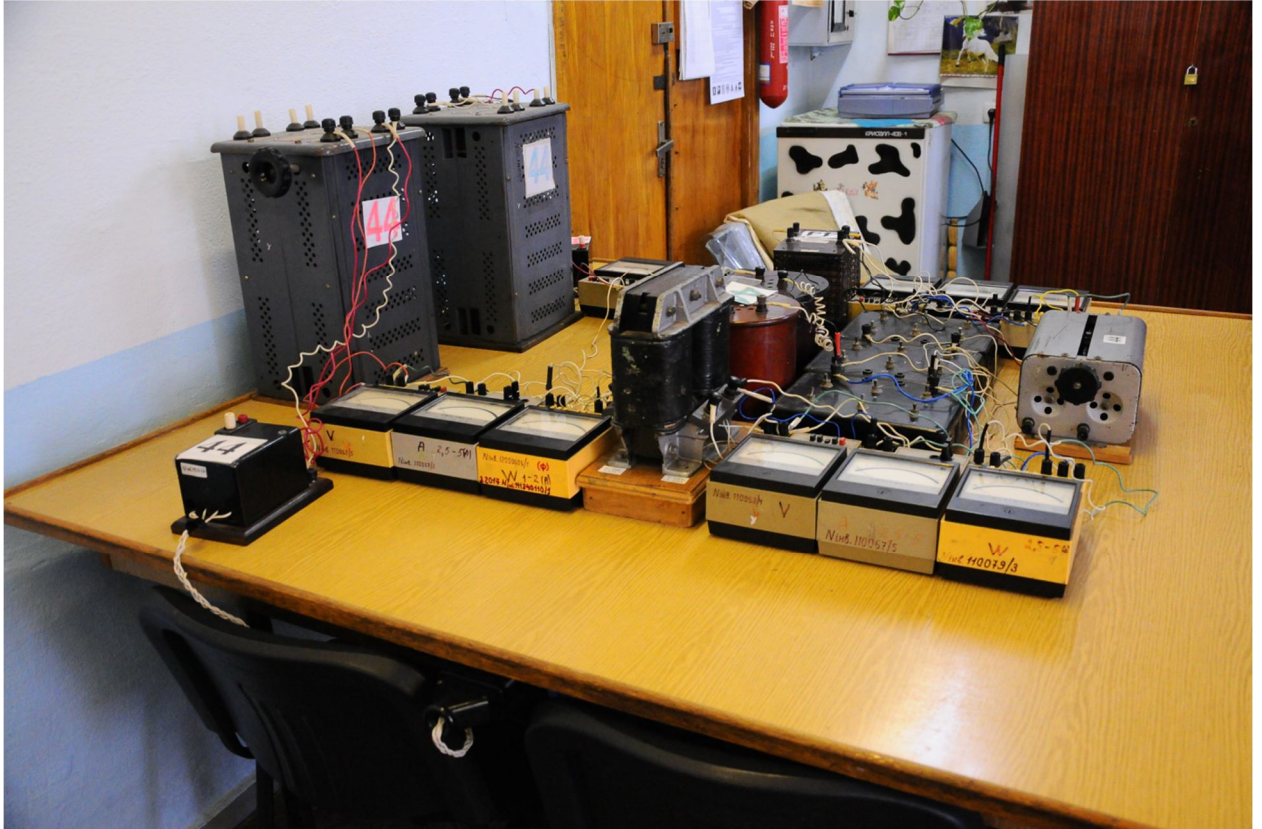
Рисунок 4 - Загальний вигляд лабораторного стенда для дослідження характеристик однофазного трансформатора з феромагнітним осердям
