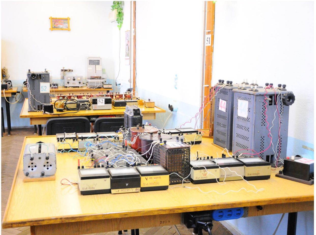
Рисунок 6 - Загальний вигляд лабораторного стенда для дослідження однорідної довгої лінії без втрат (активне навантаження)
