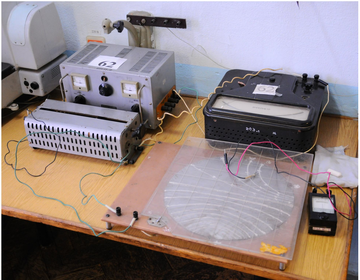
Рисунок 8 - Загальний вигляд лабораторного станда для дослідження електричного поля двопровідної лінії полем струму у провідному листі
