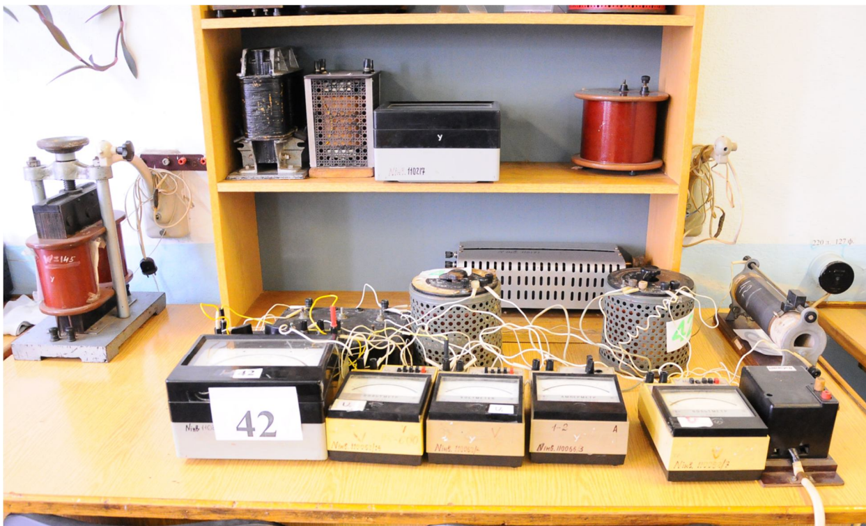
Рисунок 3 - Загальний вигляд лабораторного стенда для дослідження ферорезонансу напруг у нелінійних колах
