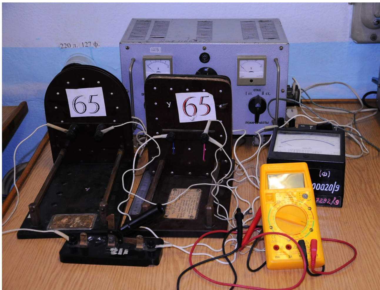
Рисунок 10 - Загальний вигляд лабораторного стенда для дослідження взаємної індуктивності круглих та прямокутних плоских котушок
