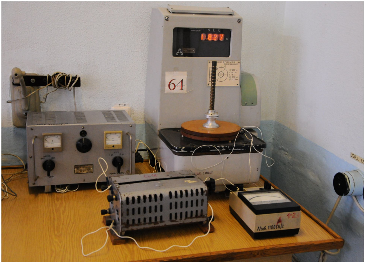
Рисунок 9 - Загальний вигляд лабораторного стенда для дослідження механічної взаємодії між двома плоскими котушками з електричними струмами
