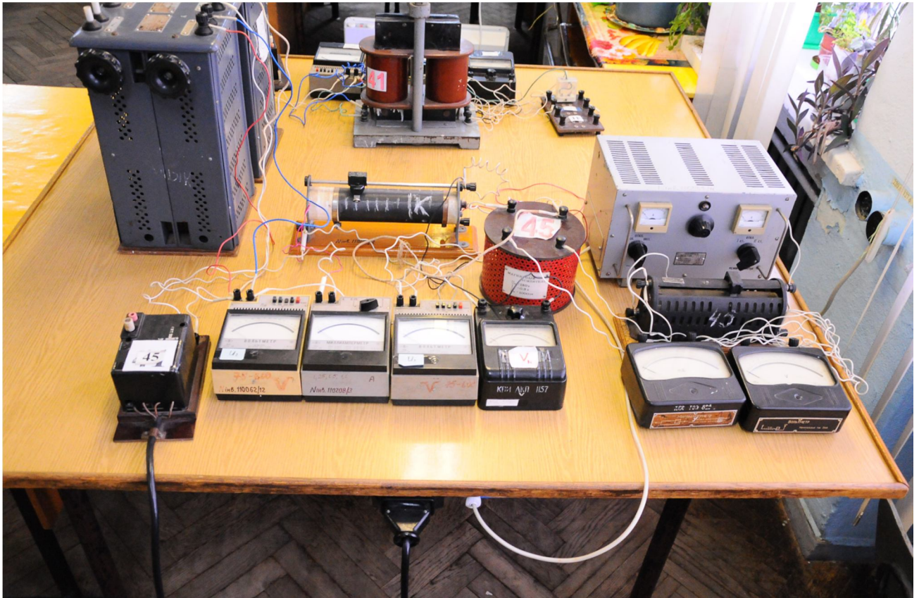
Рисунок 5 - Загальний вигляд лабораторного станда для дослідження характеристик однофазного феромагнітного підсилювача
