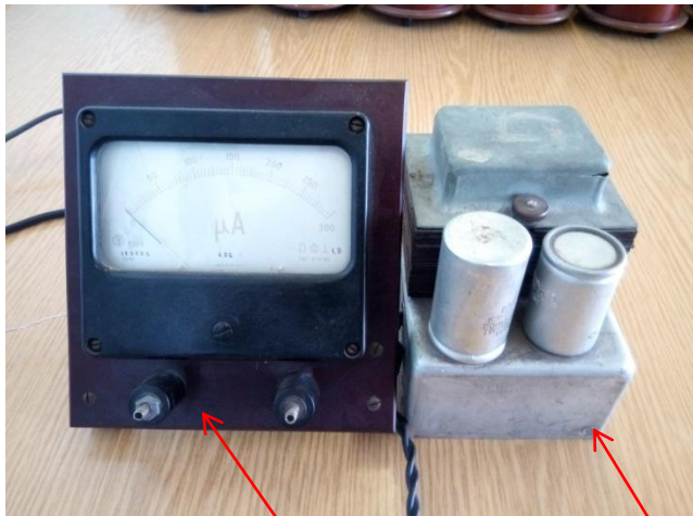
Рис. 2 Вимірювальний пристрій та високочастотний генератор
