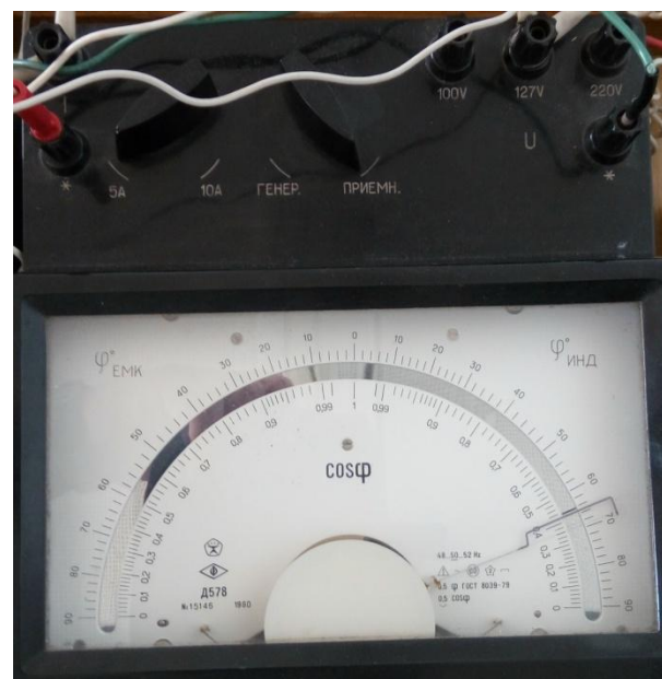
Рис. 10 Вимірювання кута зсуву фаз між напругою та струмом в режимі короткого замикання
