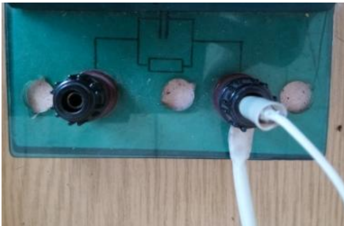
Рис. 12 Режим короткого замикання (вихідні клеми лінії приєднані до однієї точки)
