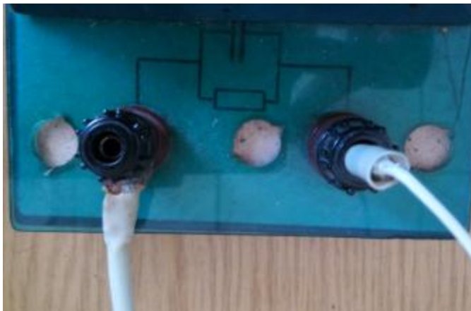
Рис. 13 Режим узгодженого навантаження (між вихідними затискачами ланцюгової схеми ввімкнуто навантаження)
