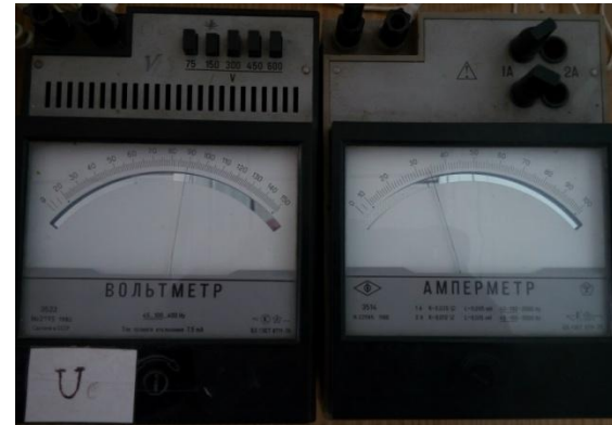
Рис. 6 Вимірювання напруги та струму в режимі неробочого ходу
