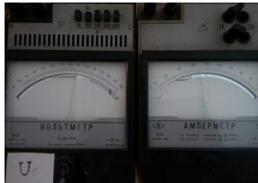
Покази приладів вольтметра ( U, В ) та амперметра ( I, А )
