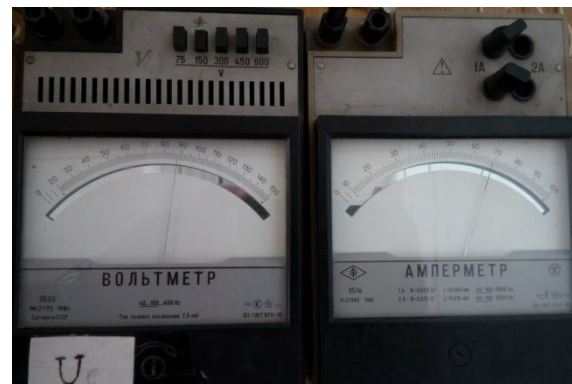
Рис. 9 Вимірювання напруги та струму в режимі короткого замикання
