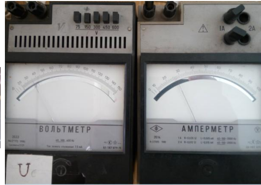
Покази приладів вольтметра ( U, V ) та амперметра ( I, A )
